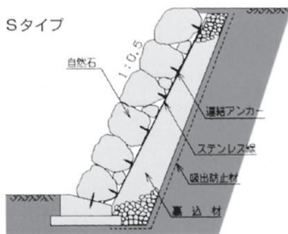
主にH=2.0m以下で施工します。
