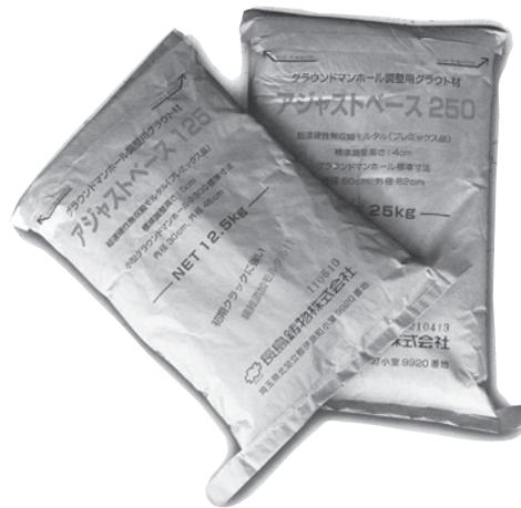
アジャストベース、超速硬セメントをベースにしたマンホール鉄蓋施工用の超速硬性無収縮グラウト材です。特殊混和剤などを配合することで、気温の影響を受けにくく年間を通じて短時間で硬化します。「崩壊しにくく」「ひび割れ」に強い、繊維添加グラウト材です。
