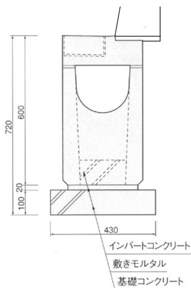
■SK集水柵スリット側溝用 200 型の製品規格図
