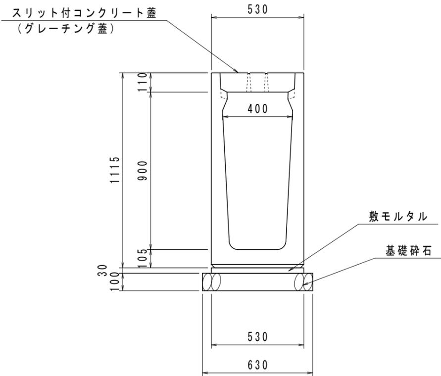
側溝平面図 S=1:20
