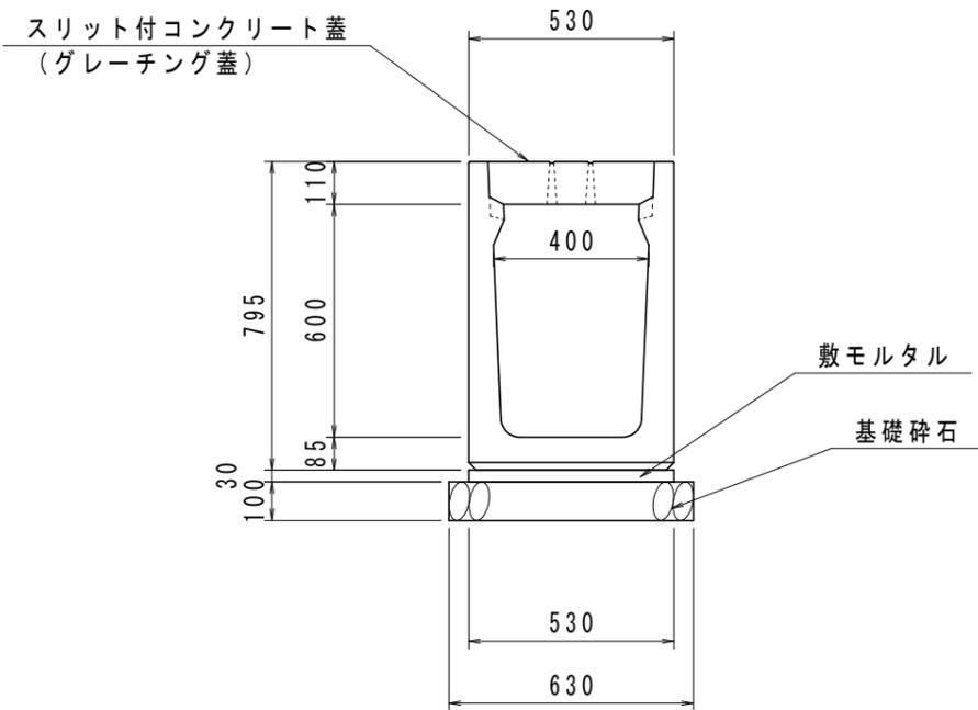
側溝平面図 S=1:20
