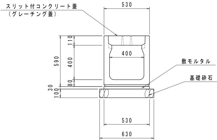
側溝平面図 S=1:20
