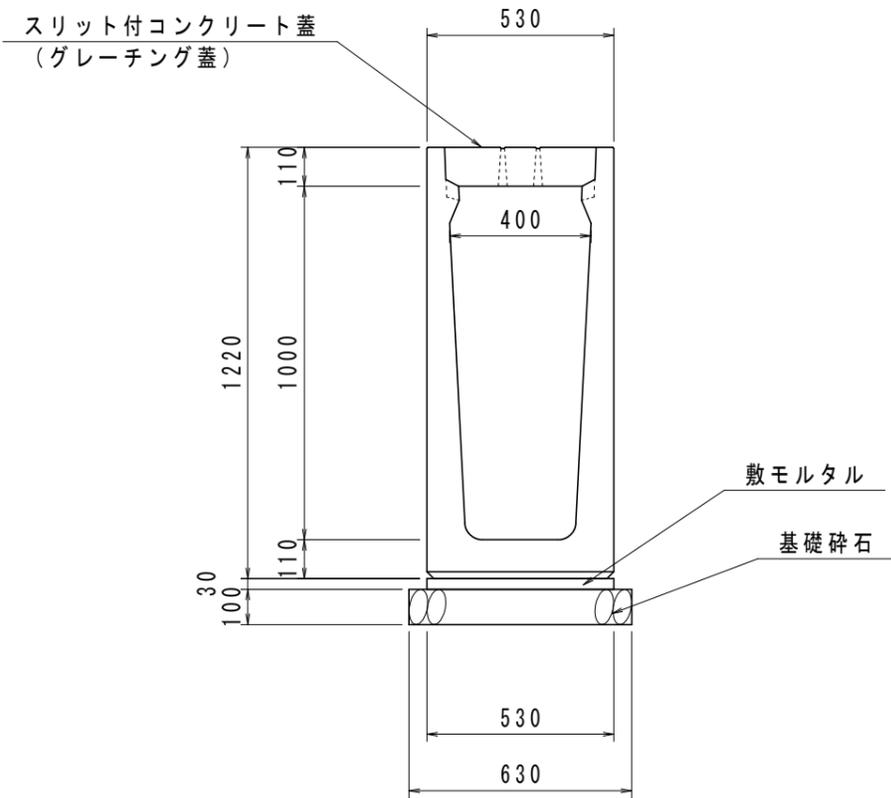
側溝平面図 S=1:20
