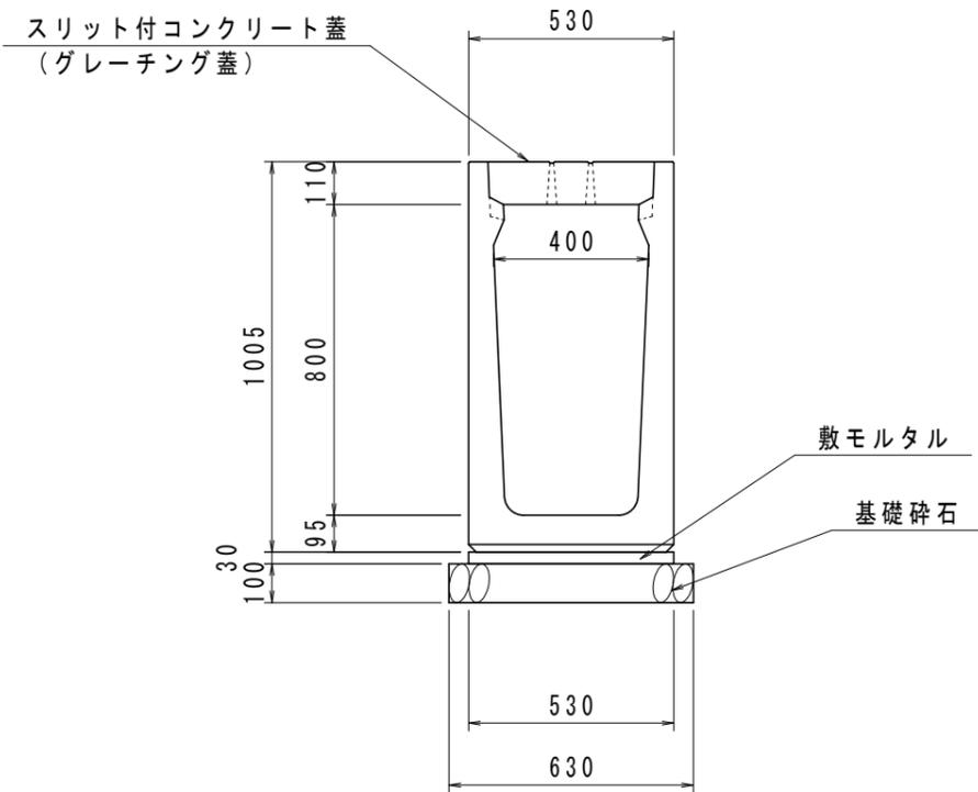
側溝平面図 S=1:20
