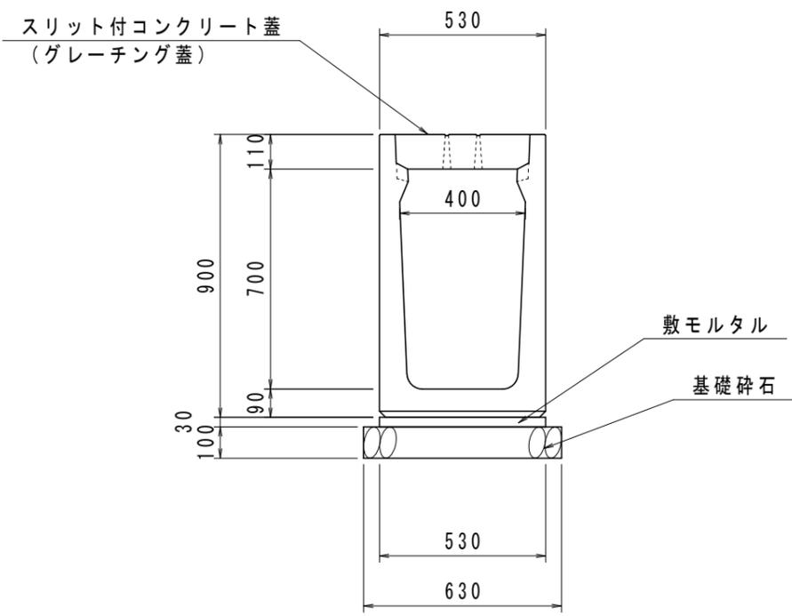
側溝平面図 S=1:20
